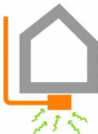
Figura 13: depressione del sottosuolo tramite pozzetto.
