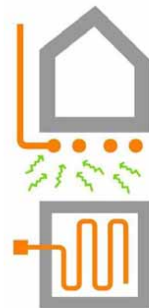
Figura 14: depressione del sottosuolo tramite tubazioni drenanti
